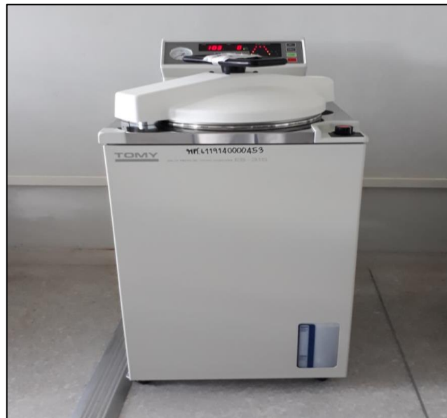
ภาพที่ ๒๘ แสดงลักษณะของหม้อนึ่งฆ่าเชื้อโดยใช้ความดันไอน้ำ (Autoclave)
