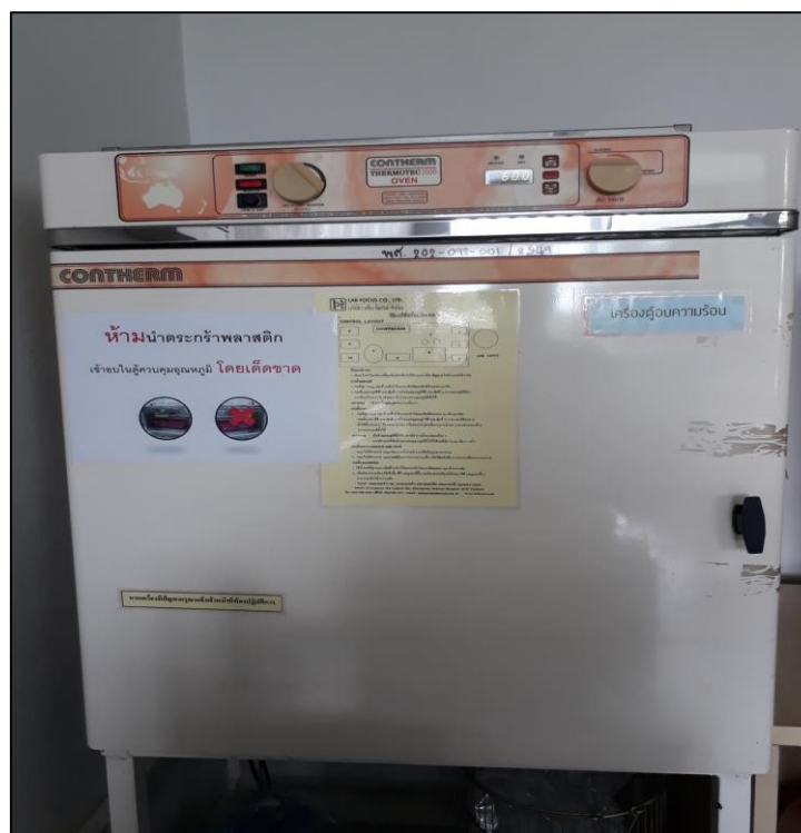
ภาพที่ ๒๙ แสดงลักษณะของตู้อบความร้อน (Hot air oven)
