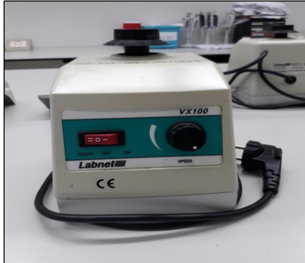
ภาพที่ ๒๖ เครื่องผสมสารละลาย (vortex mixer)
