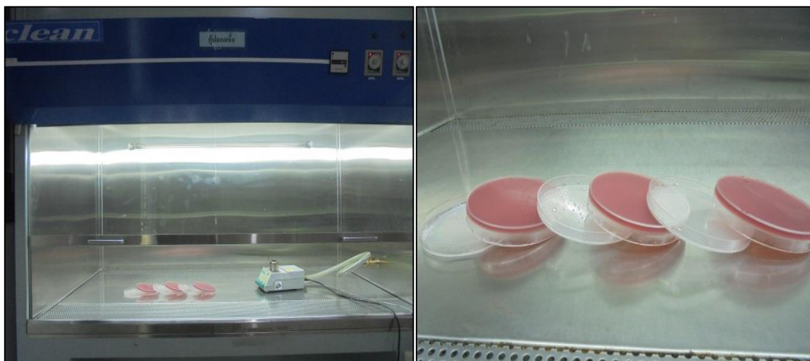
ภาพที่ ๑๓ แสดงตัวอย่างการตากเพลทอาหารเลี้ยงเชื้อในตู้ปลอดเชื้อ
