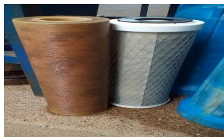
ภาพที่ 101 ดูแลระบบน้ำ โดยการเปลี่ยนไส้กรองคาร์บอนทุก 3 เดือน ซึ่งต้องมีการเปลี่ยนถ่ายสารเรซินและสารคาร์บอนทุกปี (ปีละ 1 ครั้ง)
